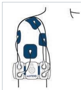
4 elektroder = 4 kabler Kanal 1 og Kanal 2
